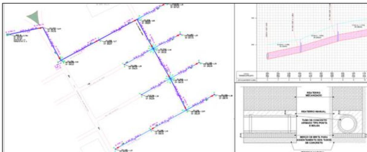
**Figura 2. Representação Técnica de Rede de Drenagem Urbana: Planta de Localização, Perfil Longitudinal e Detalhe Construtivo**
