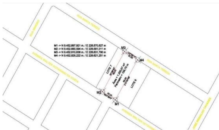
**Figura 6. Detalhe do mapa topográfico da Planalto Materiais para Construção.**
